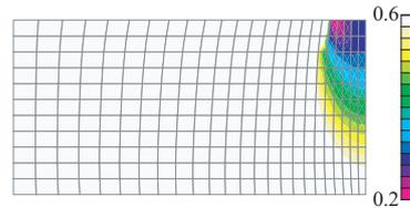
図-3 Jaumann 速度を用いた場合 (平面ひずみ, 圧縮)
