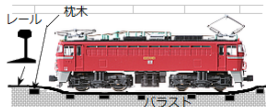
写真1.4 I形断面の身近な例はレール
